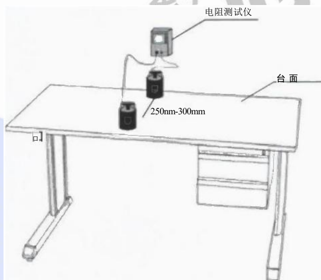
图26 工作台台面点对点电阻(竖向)测试示意图
